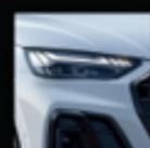
**Matrix LED** : Cette technologie innovante répartit le faisceau lumineux de façon optimale. Ceci permet d'éviter d'éblouir les conducteurs des véhicules qui vous précèdent ou arrivent en sens inverse tout en assurant un éclairage parfait des autres zones périphériques. La répartition de la lumière est garantie par l'activation et la désactivation de segments lumineux individuels. L'éclairage de la route est ainsi nettement amélioré ce qui signifie aussi plus de sécurité et de confort.
